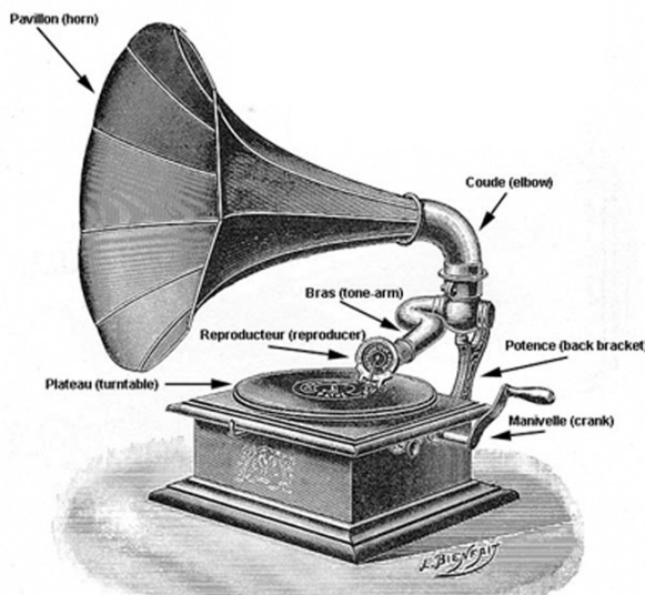
Anatomie d'un phonographe à disques
